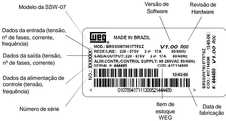
Figura 2.3 - Etiquetas de identificação da Soft-Starter SSW-07
