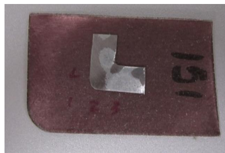
Figura 9.9 Amostra com revestimento multicamada após teste de desgaste
