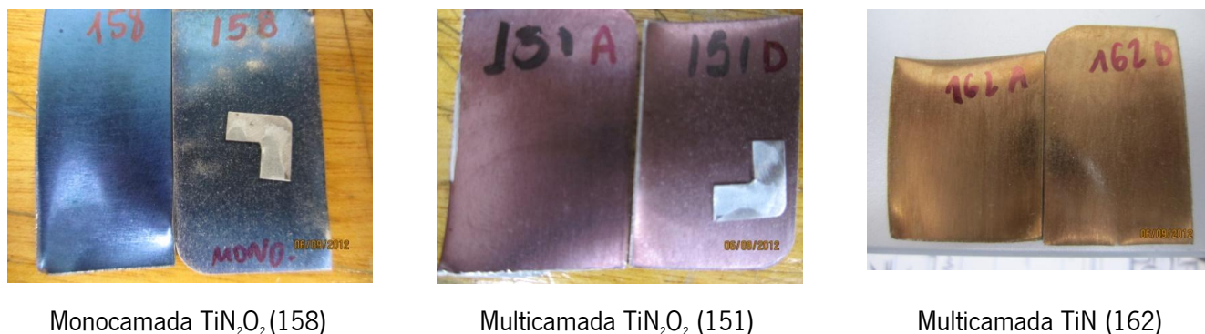
Figura 9.11 Fotos representativas de amostras de alumínio após o teste de desgaste
