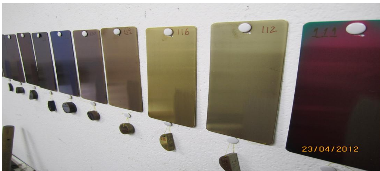
Figura 9.3 Algumas das cores obtidas com revestimentos de TiN 2 O 2
