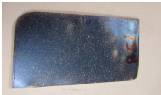
Figura 9.8 Amostra com revestimento monocamada após teste de desgaste
