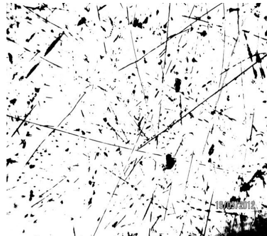
Figura 7.11 Foto tirada através do microscópio após o teste de desgaste com tratamento de imagem
