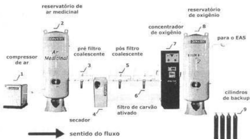
Figura 7: esquema geral de uma usina de oxigênio.
