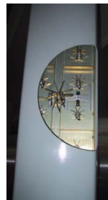
Vista interna de uma antena em painel
