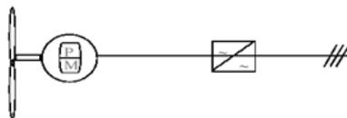
Figura 2.20: Ligação através de conversores de potência para máquinas com excitação permanente [9].
