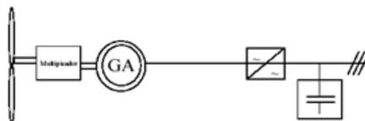
Figura 2.13: Ligação através de conversores de electrónica de potência para rotor em gaiola [9].
