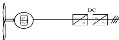
Figura 2.21: Ligação através de conversores de potência para máquinas com excitação permanente [9].
