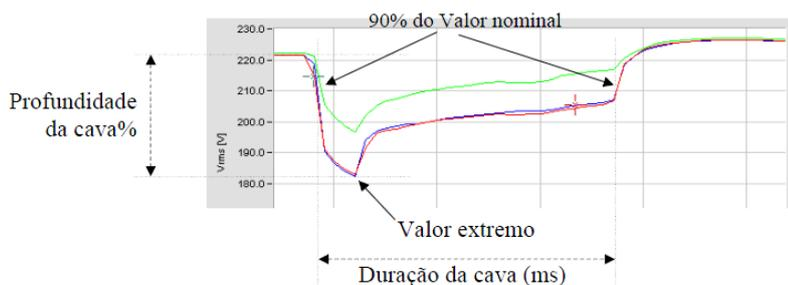
Figura 4.17: Esquema de cava de tensão [26].
