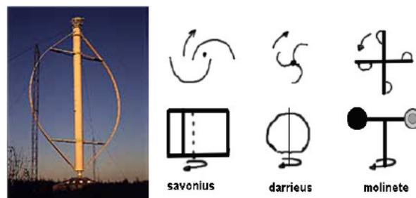
Figura 2.10: Diferentes tipos de turbinas verticais [8].
