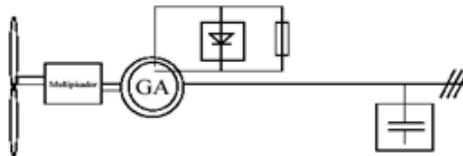
Figura 2.15: Ligação através de conversores electrónicos de frequência para rotor bobinado [9].
