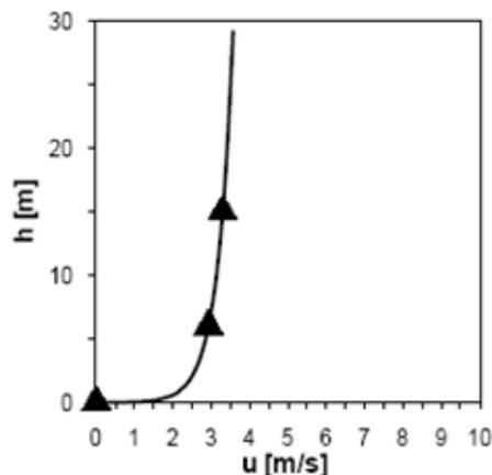
Figura 4.7: Variação da velocidade do vento com a altura acima do solo [21].
