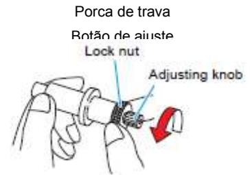
2. Utilizando uma pinça, introduza o cortador no botão de ajuste.
