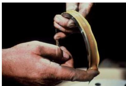
5) Limpe todas as peças e monte os retentores novos conforme mostrado nas figuras 2 a, 2 b, 2 c, 3 a, 3 b e 3 c. Preencha com graxa o anel lanterna (Q). Isso ajudará a garantir uma proteção adequada
