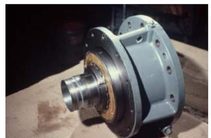
Insuficiente aperto do rolamento pode acarretar danos nos rolamentos e nos selos. Existem dois selos tipo A2 (O) que são montados conforme mostram as figuras 3a, 3b e 3c. A montagem da bucha do mancal nestes selos deve ser feita com cuidado e utilizando-se o mesmo procedimento conforme mostrado na figura 9.
