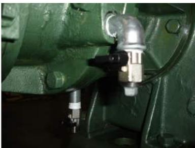
Isto é mais fácil de fazer com a bomba quente. Se for constatado que não há nenhuma contaminação, os retentores ainda estão bons. Se for constatada contaminação, a caixa do rolamento deve ser retirada conforme descrito nas instruções para retirada da rosca e os retentores devem ser trocados. Uma inspeção geral dos rolamentos e da selagem deve ser feita neste momento. Se qualquer material for encontrado no rolamento ou na graxa o retentor está danificado.
