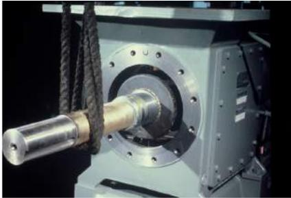
A rosca da bomba (B) (fig. 1) é feita com um eixo maciço laminado, e helicoide fabricado em barra chata conformada e soldada na posição. Suas espiras, no lado da descarga, têm revestimento em metal duro. Existe, também, o mesmo revestimento no eixo da rosca no lado da descarga. Possui, no lado do acionamento, um colo de bronze que recebe uma boa quantidade de graxa para a montagem da caixa do rolamento (I)(fig.3a, 3b e 3c).
