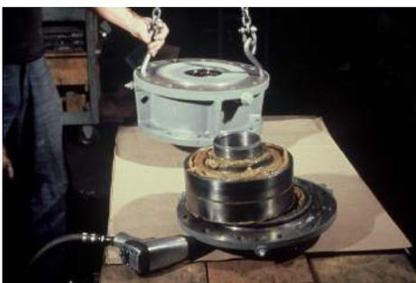
Para substituir os rolamentos não é necessário remover a rosca da bomba. Remova os subconjuntos de rolamentos conforme descrito nas instruções para a remoção da rosca.
