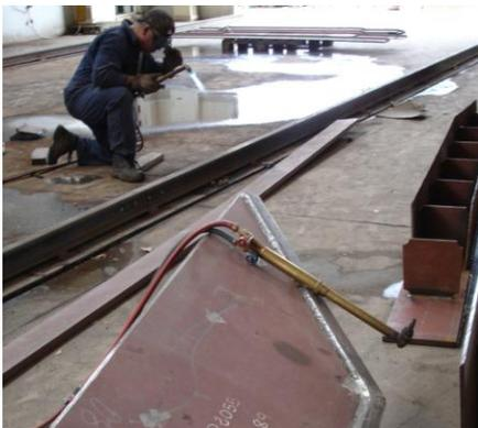
Figura 89. Maçarico de Oxi-Corte
