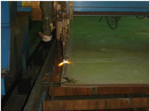
Figura 1. Máquina Automática de Oxicorte:
