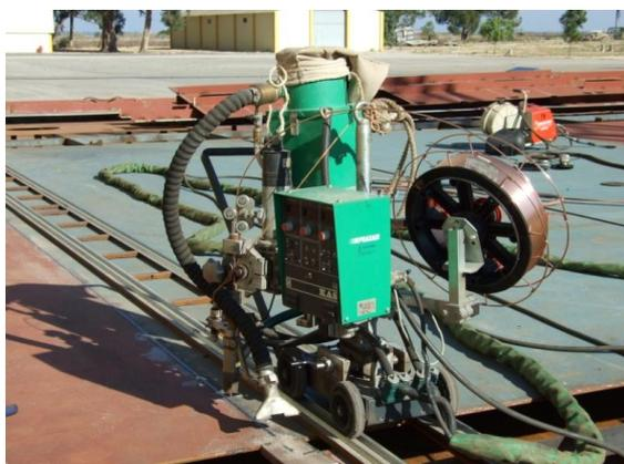
**Figura 78. Máquina de Soldadura por Arco Submerso (SAW)**
