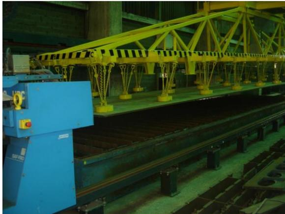
**Figura 29. Colocação da chapa de aço na mesa de corte**
