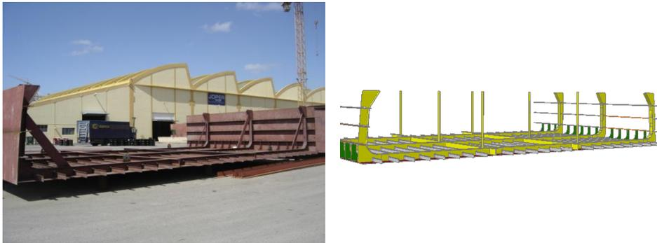
Figura 144. Bloco AC1 Vs. Modelo 3D AC1
