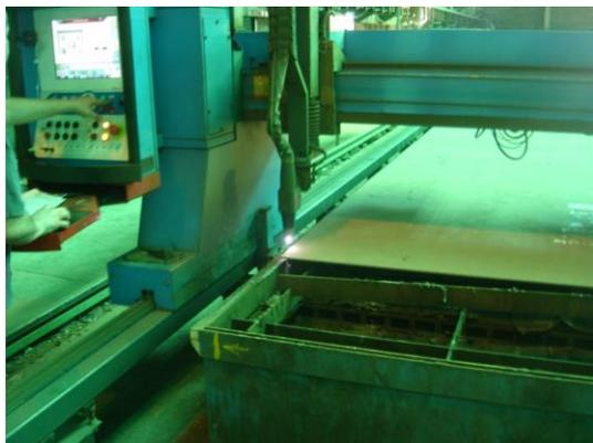
**Figura 31. Processo de alinhamento da cabeça de corte**
