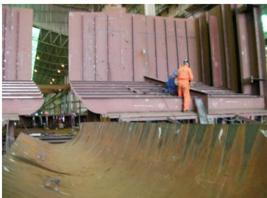
**Figura 45. Marcas em V nos bordos da chapa provocadas pela distribuição de calores**
