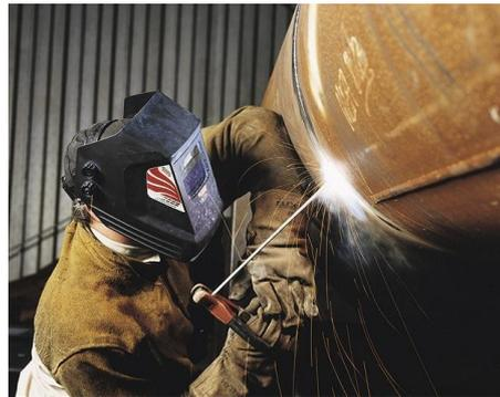
Figura 9. Soldadura por Electrodo Revestidos
