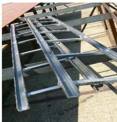
**Figura 79. Calhas guia da máquina SAW**
