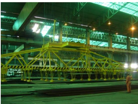
Figura 27. Ponte Magnética a transportar chapa de aço
