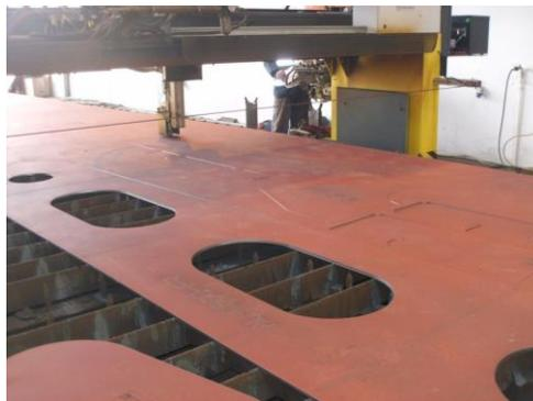
**Figura 26. Corte do nesting de uma chapa de aço**
