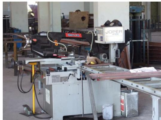
**Figura 86. Serrote Mecânico de Fita**
