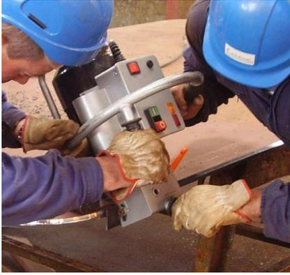
Figura 87. Chanfro mecânico num bordo de chapa
