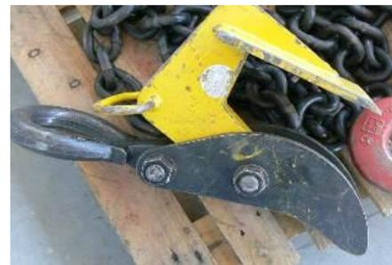
**Figura 71. Patola de Fixação Automática**
