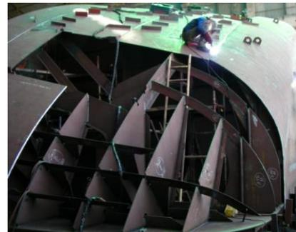
Figura 25. Bloco 8P em fase de colocação de forro
