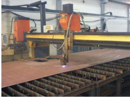
**Figura 3. Máquina de corte plasma**
