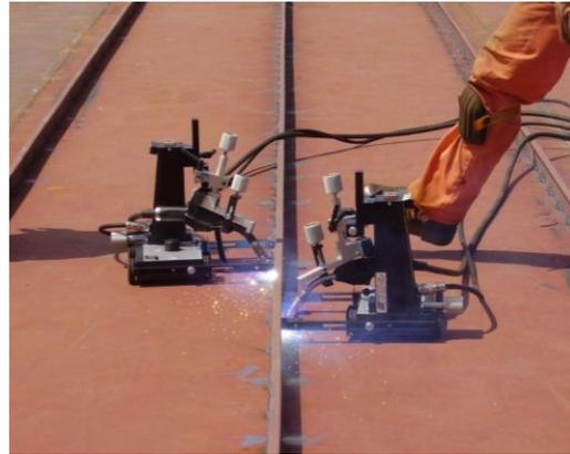
**Figura 84. Soldadura robotizada individual de um perfil de reforço**
