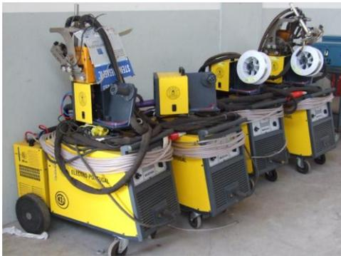
Figura 8. Máquinas de Soldadura por Fios Fluxados
