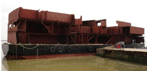
**Figura 118. Carregamento dos blocos na barça de transporte**
