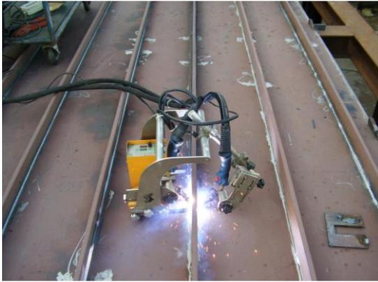
**Figura 83. Soldadura em paralelo de perfil bolbo com Robô**
