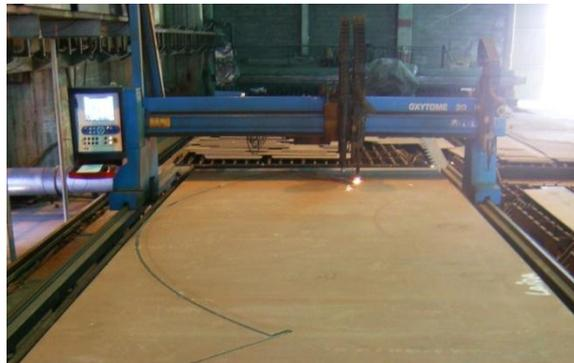
Figura 12. Máquina de corte Oxytome 30 HPC
