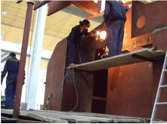
**Figura 58. Montador Naval operando maçarico de oxicorte**
