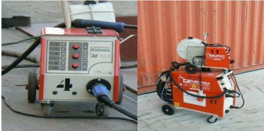
**Figura 80. Máquina de Soldadura Semi-automática MIG por Fios Fluxados**
