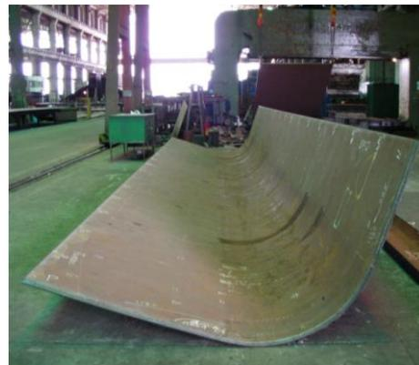
**Figura 51. Chapa de curvatura simples após enformação na calandra**
