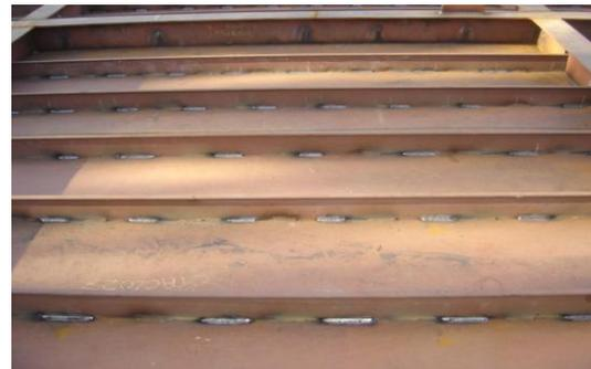
**Figura 103. Esquema de Soldadura Alternada e simbologia associada**
