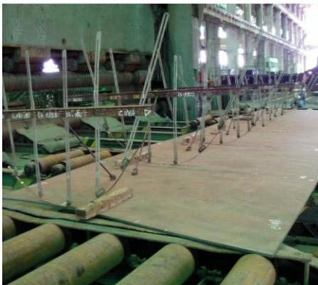
**Figura 50. Chapa de curvatura simples com cêrceas antes da entrada na calandra**
