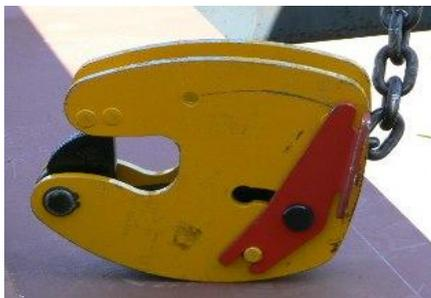
**Figura 70. Patola de Fixação Manual**
