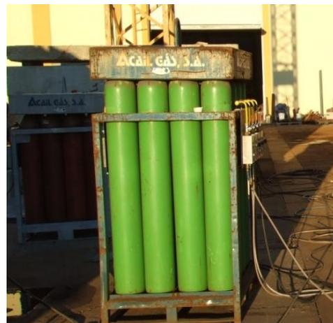
**Figura 82. Rack com botijas de Gás de Protecção (Mistura de Argon e CO<sub>2</sub>)**
