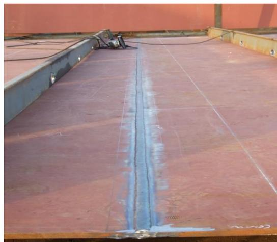
**Figura 105. Cordão de Soldadura por Arco Submerso**
