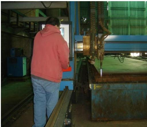
**Figura 10. Operador de corte alinha cabeça de corte com chapa**
