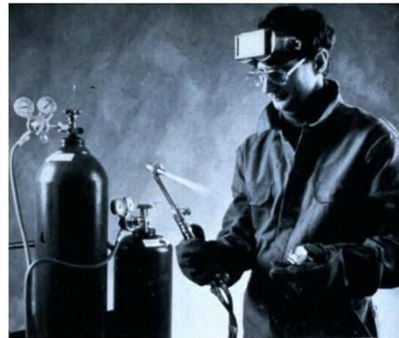
Figura 2. Maçarico para Oxicorte manual
