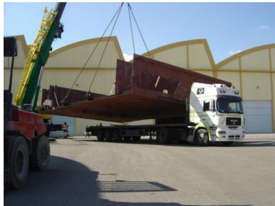
**Figura 74. Autogrúa a colocar bloco em cima da galera de camião**
