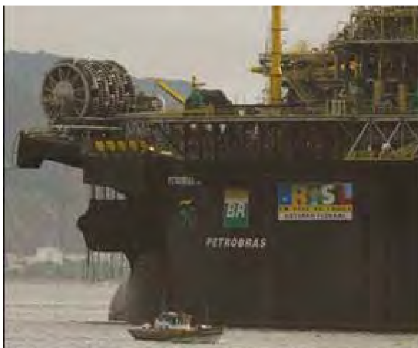
Figura II.2.4-16 - Sistema de mangotes de offloading instalado na proa de uma unidade do tipo FPSO.
