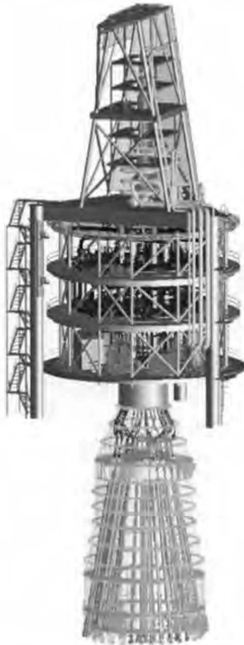
Figura II.2.4-21 - Vista isométrica preliminar da estrutura inferior e superior do turret.
