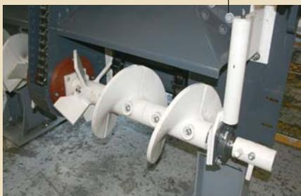
• **Capacidade de transporte até 600 ton/h:** Transportadores de massa com largura de 555 mm (largura) x 370 mm (altura), têm espaço ideal para trabalhar com massa asfáltica e bases;
