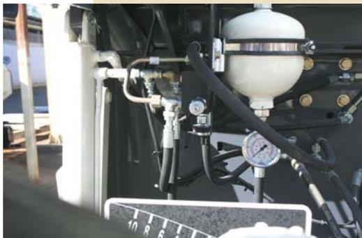
Este sistema alivia o peso da mesa alisadora a fim de que a mesma flutue sobre a massa asfáltica com o menor ângulo de ataque possível, favorecendo o perfeito acabamento do pavimento, melhor tração e resposta rápida quando for alterada a espessura aplicada.
