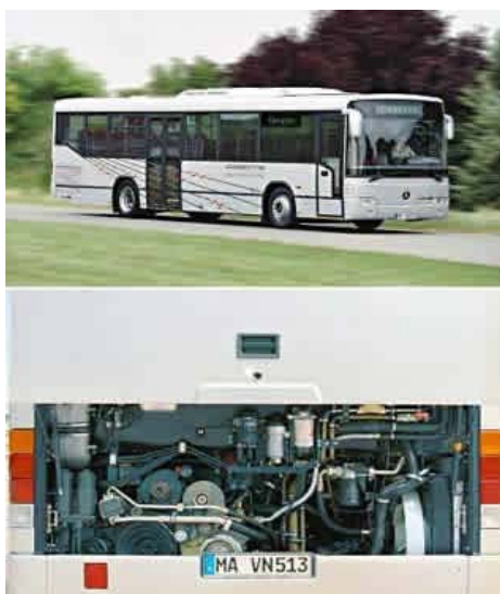
Figura 21 - Mercedes-Benz Conecto H com motor a diesel Euro 3 OM 457 hLA de seis cilindros
