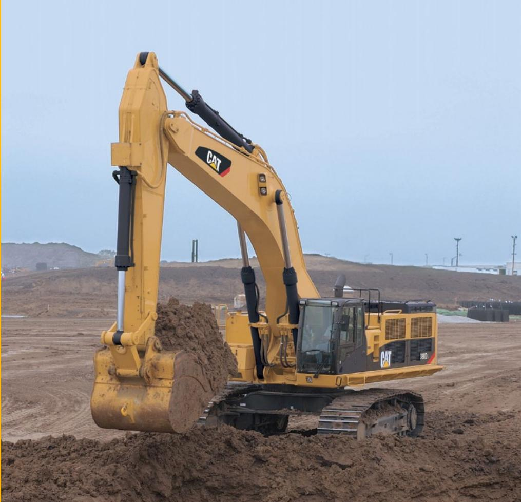
**A Escavadeira Hidráulica 390D L da Cat® tem excelente controle, alta resistência no braço e na caçamba, alta capacidade de levantamento, manutenção simples e um compartimento do operador confortável a fim de aumentar a produtividade e reduzir o custo de operação.**
