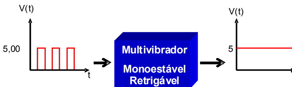
Figura 3-36 – Estrutura de funcionamento do multivivrador monoestável
