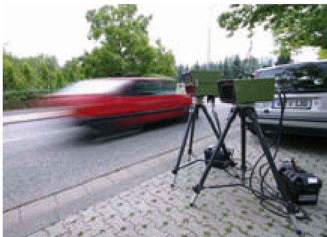
**Figura 19 – Sistema Lidar**
