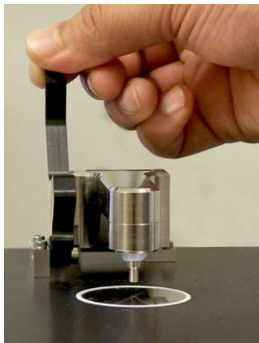
Figura 9. Abertura do acessório de prensagem de amostra
