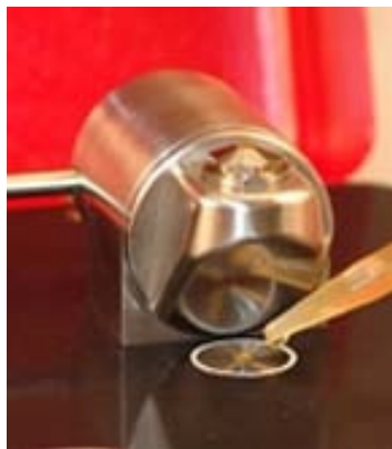
Figura 6. Aplique uma amostra na janela da parte de baixo da Tumbler
