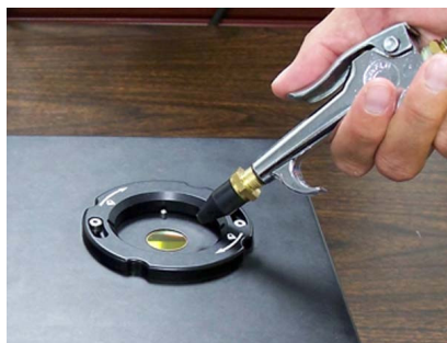
Figura 12. Limpar a interface de amostra
