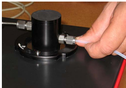
Figura 14. Encaixe da mangueira de gás de purga na entrada da célula de gás
