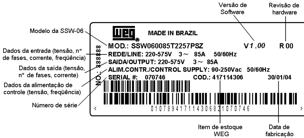
Figura 2.2 - Etiquetas de identificação da Soft-Starter SSW-06
