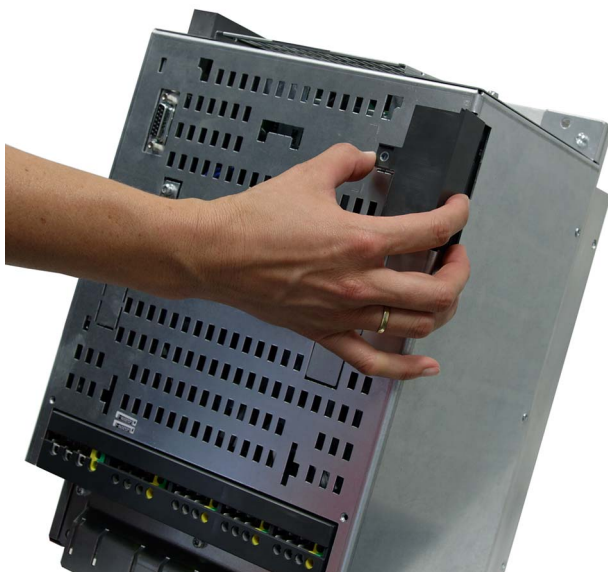
Remoção da cobertura do circuito intermediário
