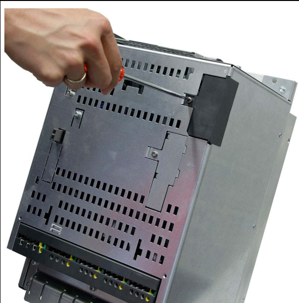
Remoção do parafuso Torx da cobertura do circuito intermediário
