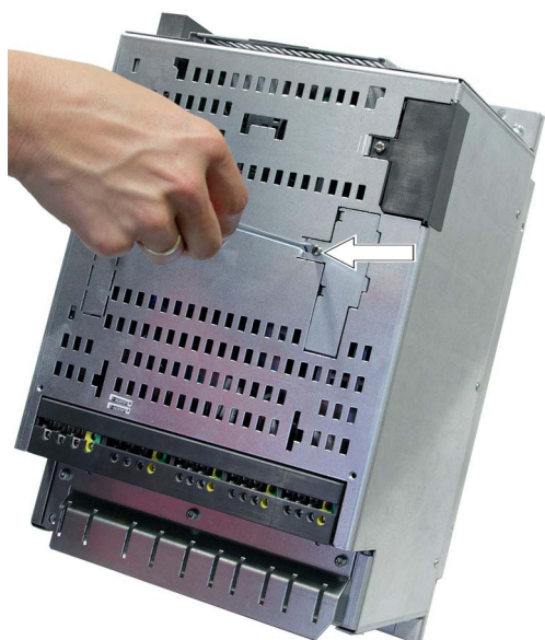
2. Remoção do parafuso Torx da cobertura do ventilador
