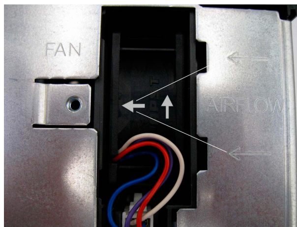
Esquema 14-1 Setas no ventilador para a direção do fluxo
