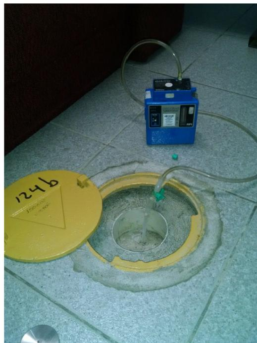
**Foto 02:** Poço de monitoramento de gás PMG-124 B, localizado no Transporte. Procedimento de purga antes da amostragem.
