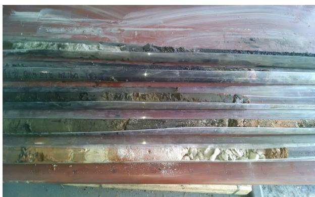
**Foto 07:** Perfil litológico obtido durante a perfuração utilizando amostrador descartável do tipo *linner*.
