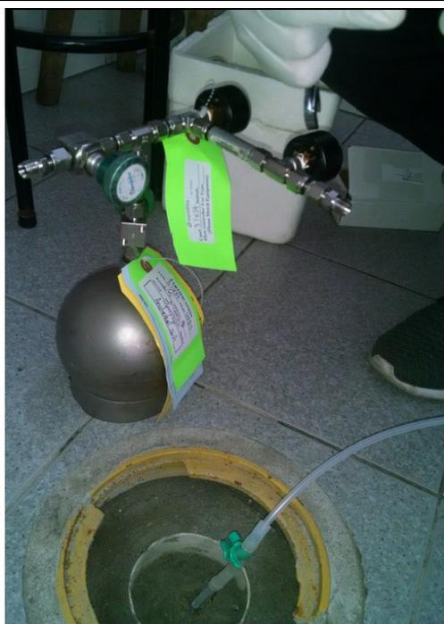
**Foto 01:** Coleta de amostra de gás em poço localizado no edifício de Transportes, utilizando amostrador tipo *canister*.
