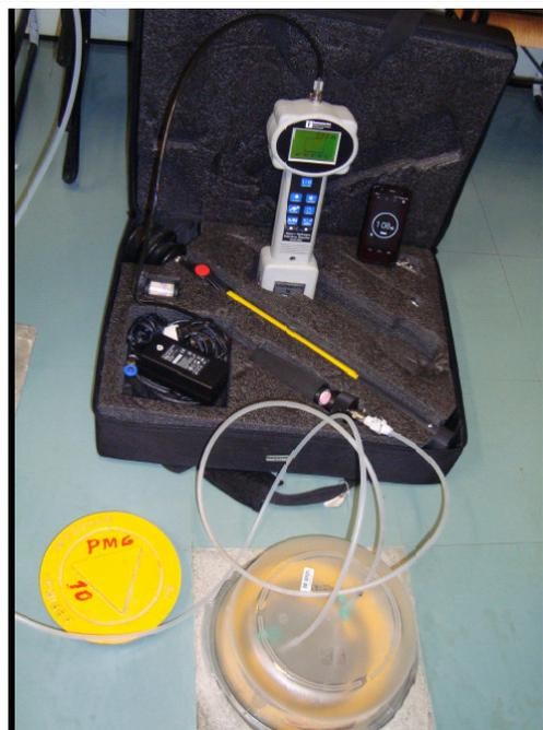
**Foto 03:** Teste de estanqueidade em poço de monitoramento de gás – PMG-10.
