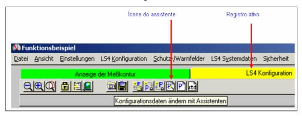
Entre outros, você pode ajustar com o assistente quais os pares de áreas que devem ser liberados na ligação do LS4. No exemplo preparado tratase do par de áreas 1 (área de proteção 1 e área de alarme 1).
