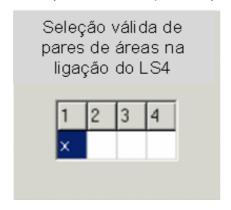
Também pode ser ajustado com o assistente quais os pares de áreas que podem ser acionadas. No exemplo preparado é possível o chaveamento do par de áreas 1 para 2 e do par de áreas 2 para 1. O par de áreas 3 e 4 não está preparado neste exemplo.
