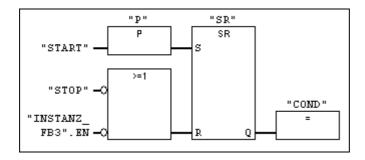
Na rede 1 é dado o sinal para a ligação operacional (START) e o requerimento de desligamento (STOP) para o atuador (aqui simulado por uma lâmpada de sinalização).
