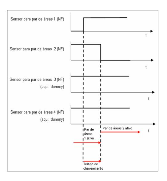
Este status pode (dependendo da aplicação) representar um risco eventual (p. ex. se o sensor a acionar para o chaveamento não reagir). Neste exemplo este status é identificado e comparado com um tempo parametrizado. Se este status permanecer depois da terminação deste tempo, isto é interpretado como erro e o bit #ERR\_SW\_TIME é colocado (veja quadro seguinte).
