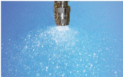
Ataque da umidade externa é simulada pela pulverização de água pura sobre as amostras.
