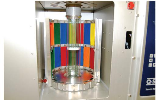
Apresentando um projeto de tambor rotativo, resfriamento a ar muito confiável e com uma gama completa de filtros óticos, o Q-SUN Xe-2 é o mais novo padrão em testes de resistência à luz e intemperismo.
