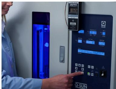
O Xe-2 permite a irradiância precisa e controle de temperatura.
