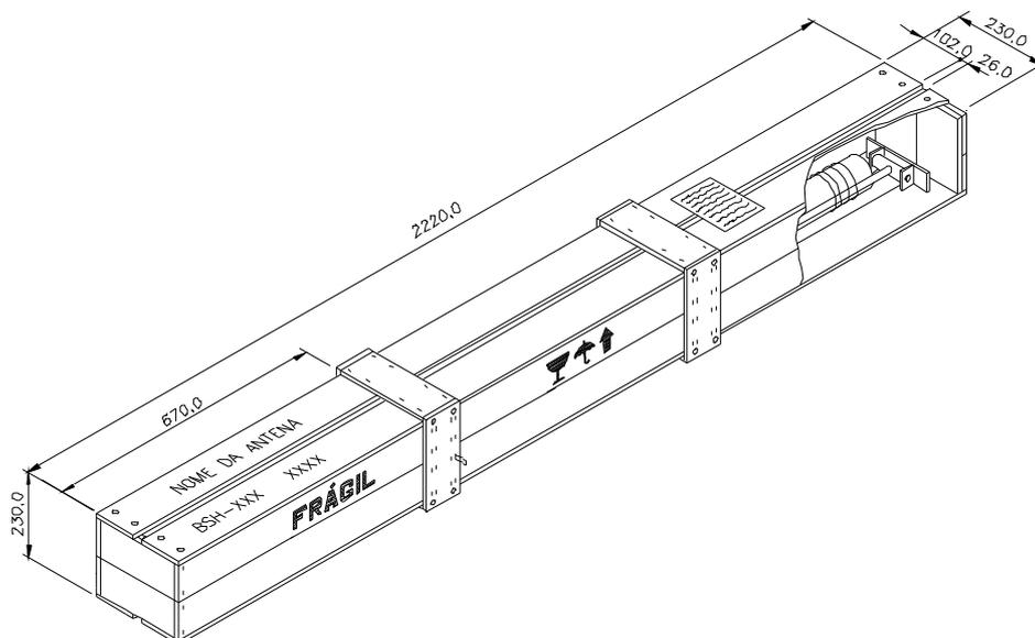
**FIGURA 07** – Barra estabilizadora / embalagem
