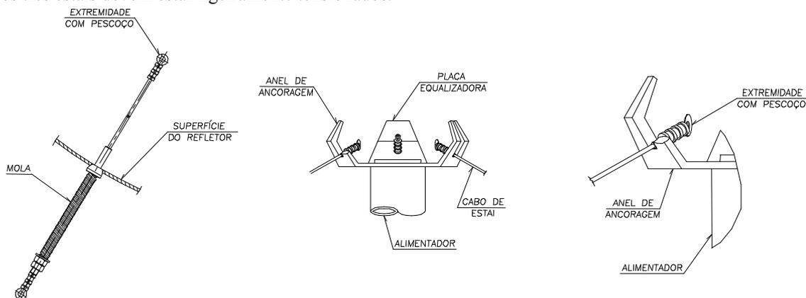
FIGURA 09 – Montagem dos cabos de estai
