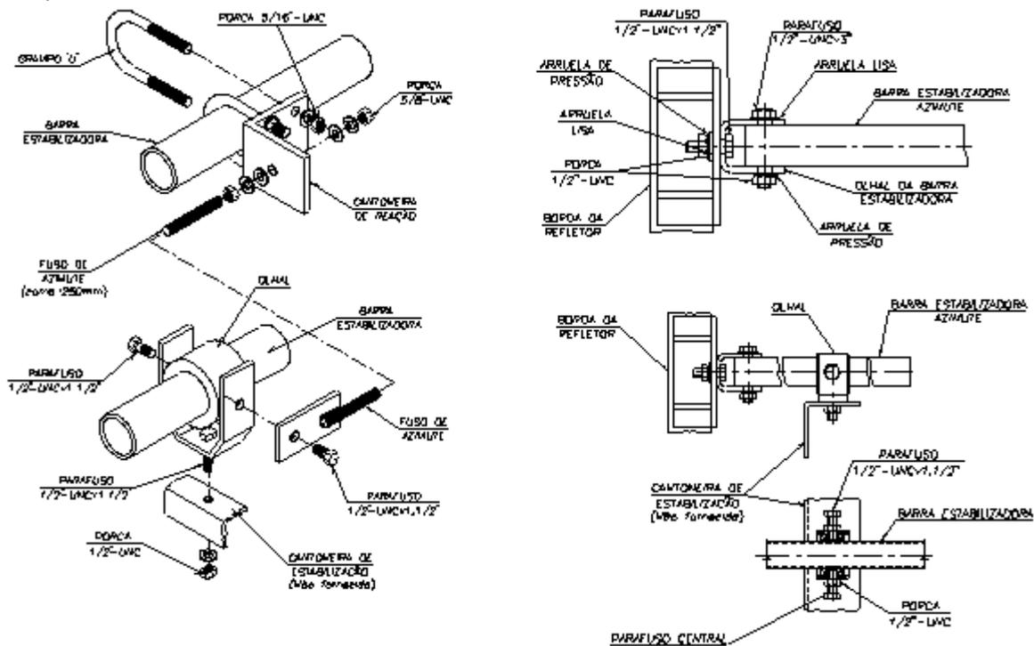
FIGURA 13 – Fixação da barra estabilizadora
