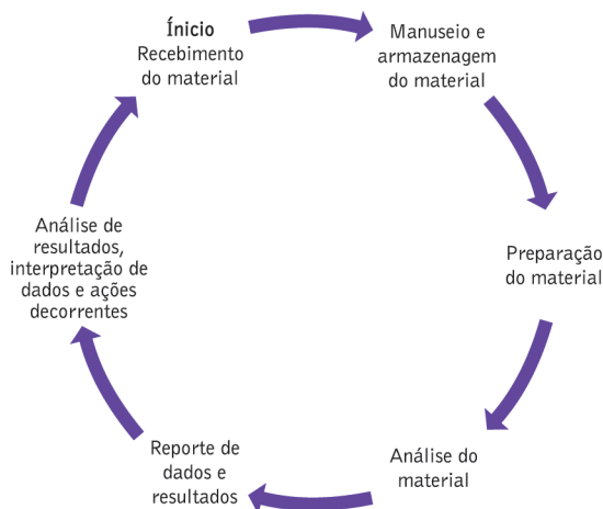
Figura 7: Ciclo de uma rodada de ensaio de proficiência no laboratório
