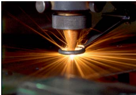
Máquina de corte de chapas a laser: alta precisão e produtividade.
