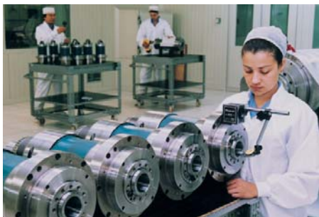
Os cartuchos dos eixos-árvore são montados em sala ultralimpa, onde a temperatura, a umidade relativa do ar e a quantidade de partículas em suspensão são controladas.
