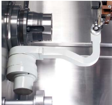
Leitor de posição de ferramentas
