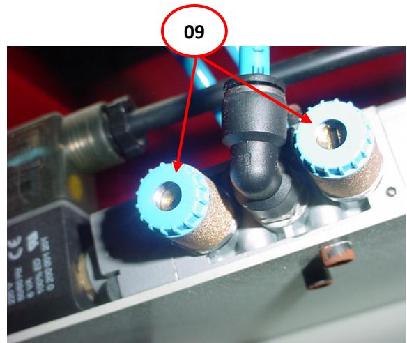
Também poderá ser regulada a velocidade de corte da fita através dos parafusos da válvula pneumática (posição 09). Utilize chave de fenda.
