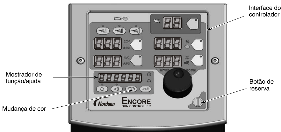
Figura 4-1 Comandos do sistema - sistema móvel ilustrado
