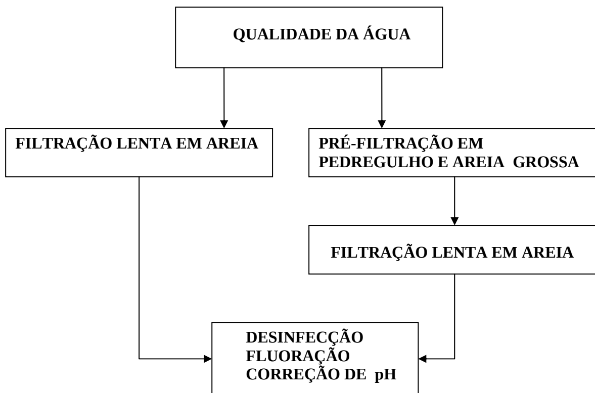
Figura 15. Fluxograma de instalações de tratamento com pré-filtração e filtração lenta
