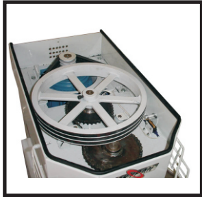
Sistema de Transmissão Superior
