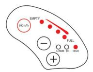
5. Prima o botão "+" até que as 3 luzes (low, med, high) se acendam como se mostra na figura, que significa que não há assistente de potência, entretanto pode utilizar o acelerador para controlar a bicicleta eléctrica.
