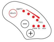
6. Prima o botão "-" até que as 3 luzes (low, med, high) se apaguem como se mostra na figura. Isto significa que não há assistente de potência nem controlo do acelerador.
