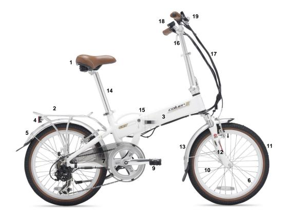
1 Selim 2 Suporte traseiro 3 Bateria 4 Luz traseira 5 Guarda-lamas traseiro 6 Aros 7 Protector de corrente 8 Cubo com motor eléctrico 9 Pedais 10 Raios 11 Pneus e Câmaras 12 Forqueta 13 Guarda-lamas da frente 14 Espigão de selim 15 Quadro 16 Guiador e Avanço 17 Cabos 18 Display/Controlador 19 Campainha
