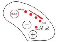
3. Prima o botão "+" e acende-se a segunda luz, como se mostra na figura, que significa assistente de média potência e velocidade de 20 km/h.
