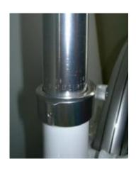
3. Preste atenção às marcas indicadoras de inserção mínima (MIN. INSERTION) no espigão de selim. As marcas não devem ficar à vista.
