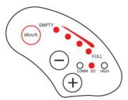
4. Prima o botão "+" e acende-se a terceira luz, como se mostra na figura, que significa assistente de alta potência e velocidade de 25 km/h.
