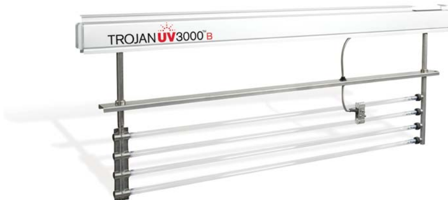
Os módulos avançados e autossuficientes do TrojanUV3000™PTP e do TrojanUV3000™B incorporam reatores resfriados por convecção e possuem um indicador de status da lâmpada UV (abaixo) para confirmação imediata de que todas as lâmpadas estão em funcionamento.
