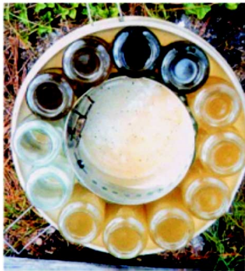
Figura 3.21 Amostradores de qualidade da água pluvial. Início da precipitação com a garrafa marrom (posição do relógio a 45 min)
