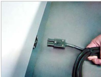
A figura mostra como conectar o plug na tomada de força na base da mesa. Para carregar a bateria, conecte o plug correspondente do carregador na base da mesa e ligue-o na rede elétrica.
