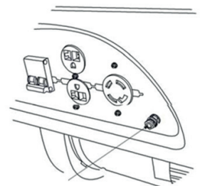
Ligando fio de aterramento no gerador
