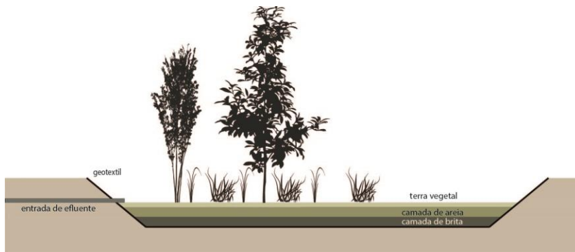
Figura A.34: Esquemática de uma plataforma de evaporação
