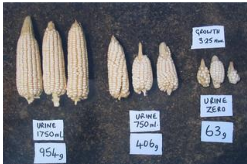
Figura 4.2: Testes do efeito da aplicação de urina no crescimento do milho. Aumento da quantidade de urina adicionada da direita para a esquerda, a primeira amostra não tem qualquer aditivo e a amostra mais à esquerda teve uma adição de 1750 ml de urina. Fonte: Peter Morgan.
