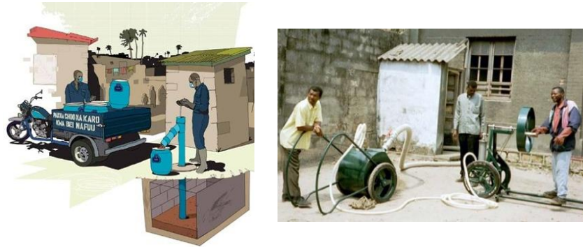
Figura A.22: Exemplos de remoção de lamas de fossas recorrendo a equipamento manual. À esquerda pode ser vista a ilustração da utilização do Gulper (fonte: WaterAid America), e à direita o sistema MAPET (fonte: SWWM)
