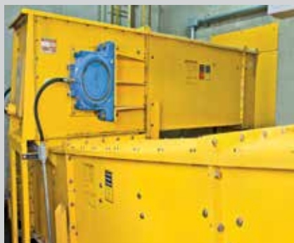
TCRA PARA DESCARGA DE MOEGA
