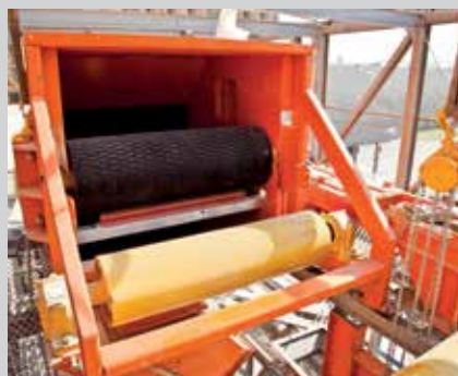
CORREIA TRANSPORTADORA 1.500 t/h (54")
