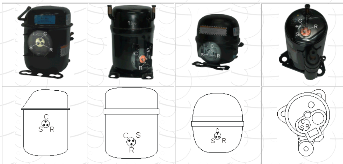
Posição dos bornes de compressores herméticos.
