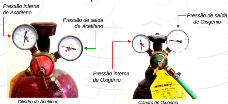
Válvulas reguladoras de pressão.
