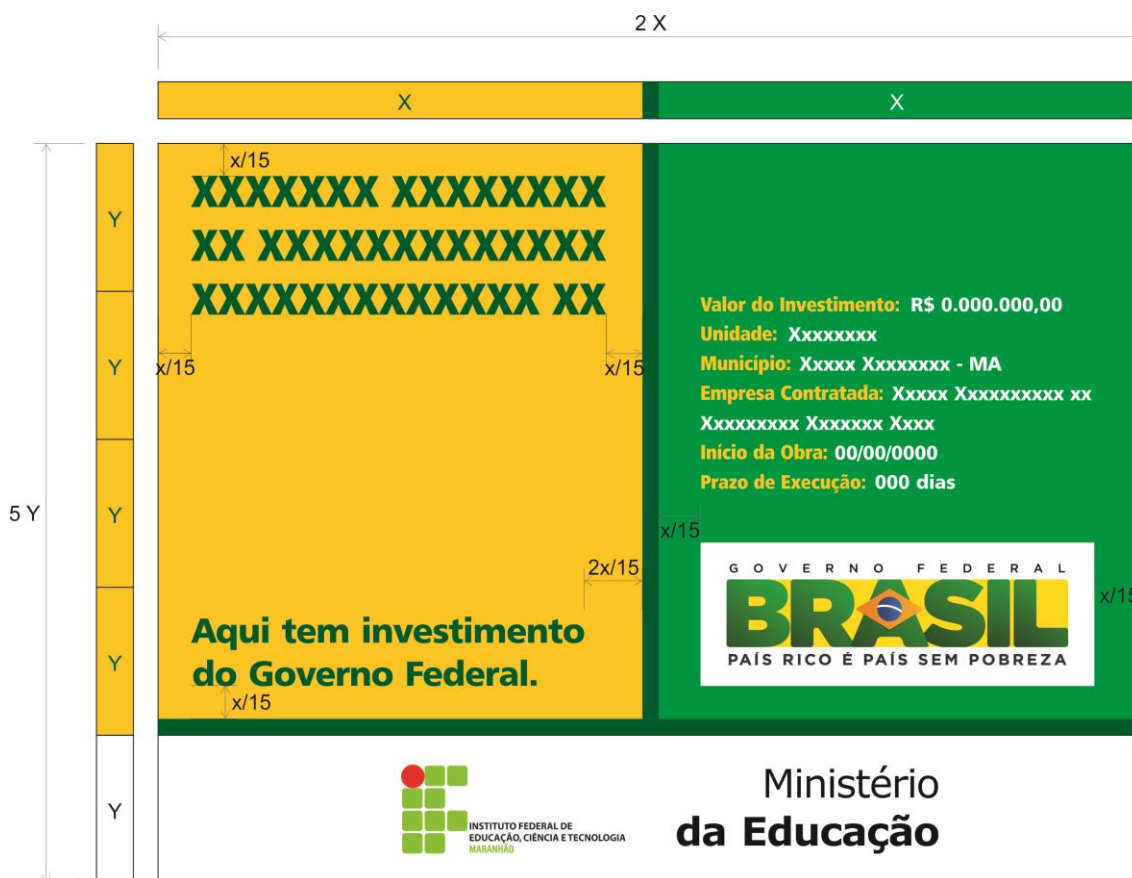
Fig. 02 – Padrão geral de construção da placa da obra
