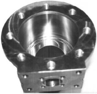
1. O corpo é colocado no seu flange de entrada, cubo grampeado ou extremidade soldada com a cavidade do corpo direcionada para cima.
