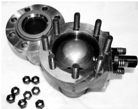
6. Remova a vedação ou junta do corpo dependendo do design da válvula
