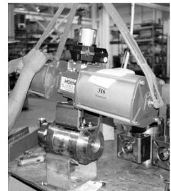
9. Todas as placas do adaptador do operador fornecidas pela ValvTechnologies têm um orifício usinado no meio da placa. Quando esta placa for montada à válvula, ela deverá estar concêntrica com o eixo antes dos parafusos que seguram a placa de montagem serem apertados. Após apertar os parafusos, a concentricidade deverá ser verificada novamente. Qualquer desalinhamento do operador com a válvula poderá causar um entortamento no operador o que poderá causar danos à válvula ou ao operador.
