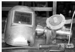
O uso de protetores contra radiação é recomendado se o dano pelo calor ao atuador for uma preocupação. Cuidado deve ser tomado para minimizar as escórias e os resíduos da solda dentro da válvula. Não bater nos arcos na válvula.
