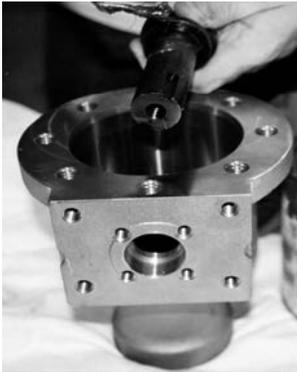
2. A haste será inserida através do seu orifício a partir do lado da cavidade do corpo.
