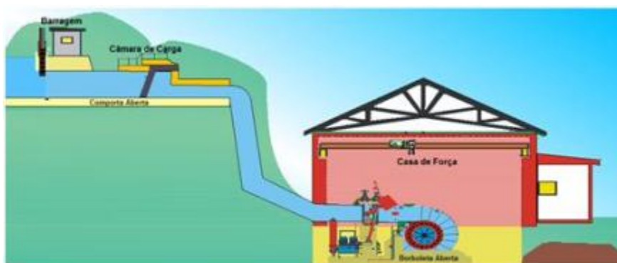
Figura 8 – Demonstração de Pequena Central Hidrelétrica
