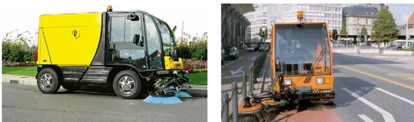
Figura 63 – Exemplos de veículos de varredura automática
