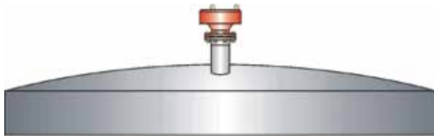
Figura 1: Alívio do tanque de armazenamento com PROTEGO® EH/OS
