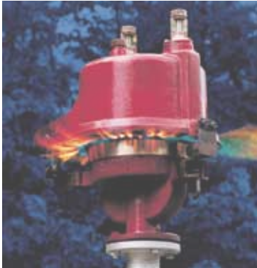
Figura 3a: Teste de combustão contínua da válvula de diafragma PROTEGO® UB/SF
