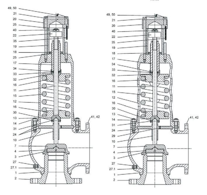
**Tipo SB..**Válvula de segurança com fole de equilíbrio e capacete com respiro, para vapores, gases e líquidos
