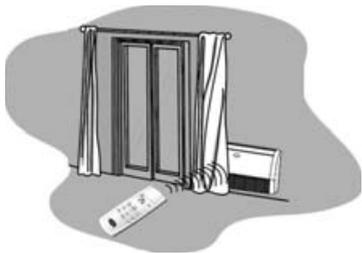
Se o receptor de sinal infravermelho na unidade interna for exposto diretamente aos raios solares, o aparelho não funcionará adequadamente. Bloqueie a incidência dos raios solares até eliminar a exposição.
