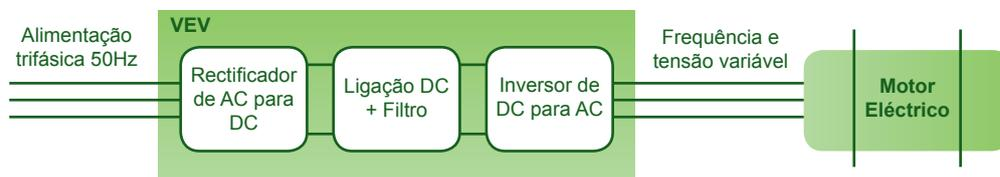
Fig. 2.6/ Configuração de um VEV.
