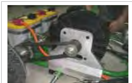
Fixação motor ao chassis e transmissão às rodas por correia dentada
