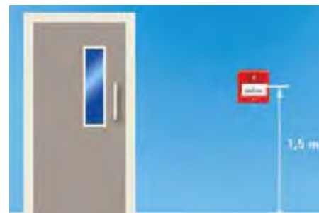
Figura 11 - Altura das Botões Manuais de Alarme
