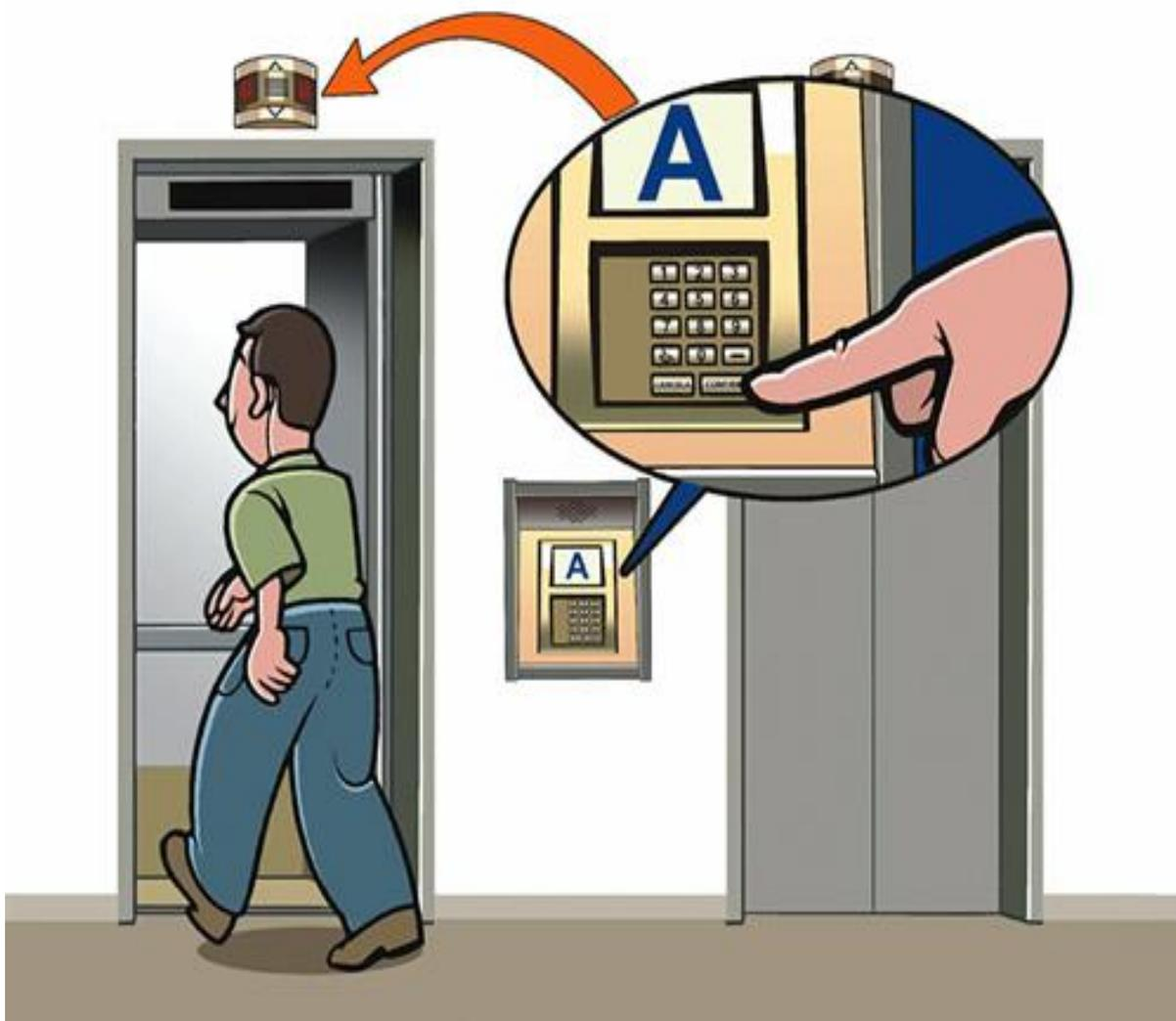
**Figura 14 - Sistema de chamado unificado.**
