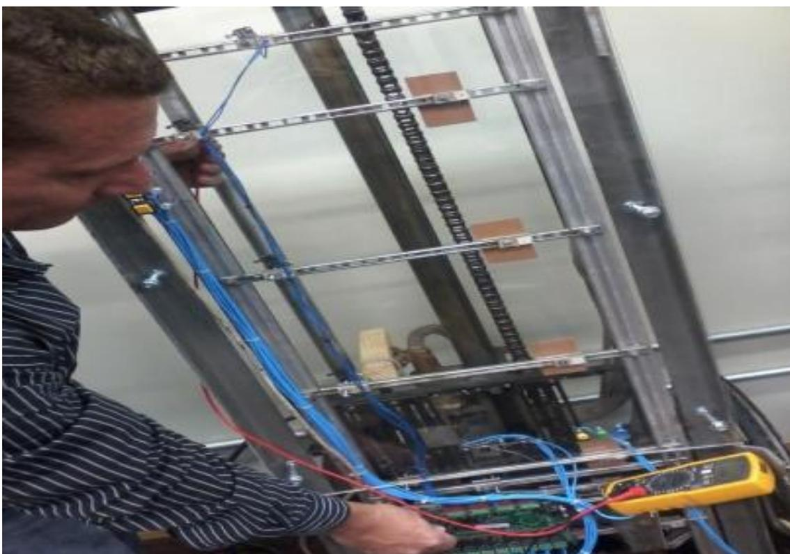
Figura 34 - Teste de alimentação dos sensores.
