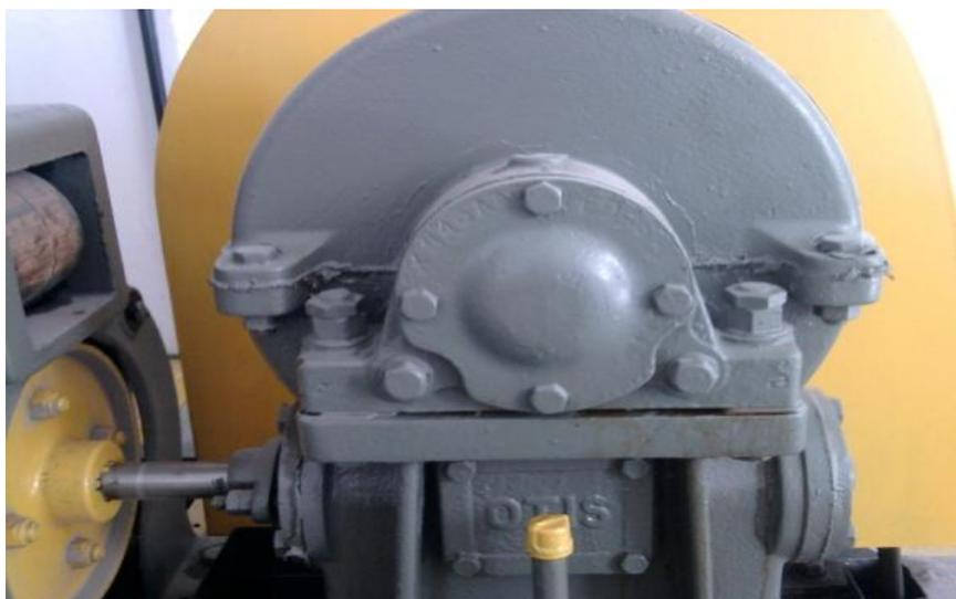
**Figura 8 - Conjunto motor e redutor para tração da cabina com cabos de aço**
