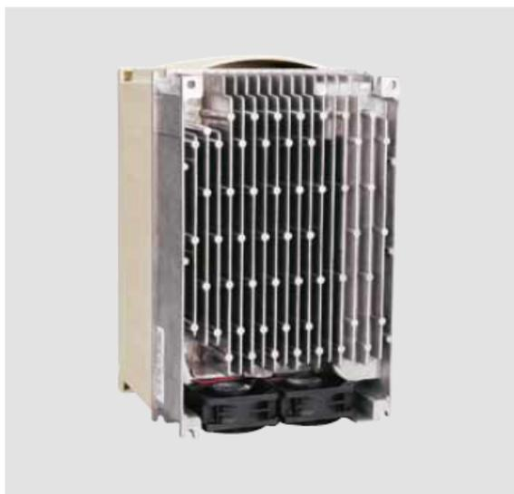
Os Inversores CFW09 permitem montagem flexível, sendo possível, além do modo de fixação tradicional pela Base, também o modo de fixação pela Flange, possibilitando desta forma montar o dissipador de calor para trás da placa de montagem.
