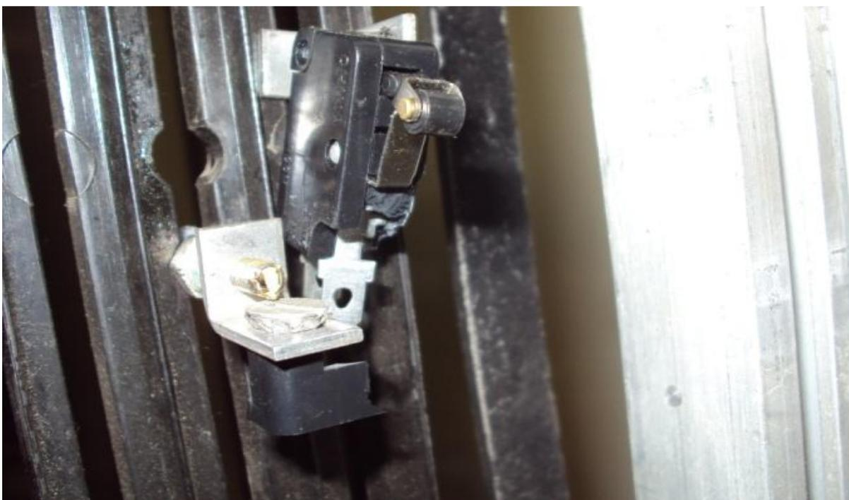
**Figura 22 - Micro switch utilizado para sensor de desaceleração.
