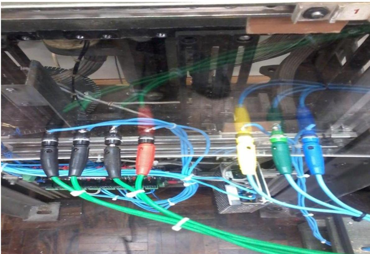
Figura 26 - Conexões para comunicação da torre com a bancada do inversor.
