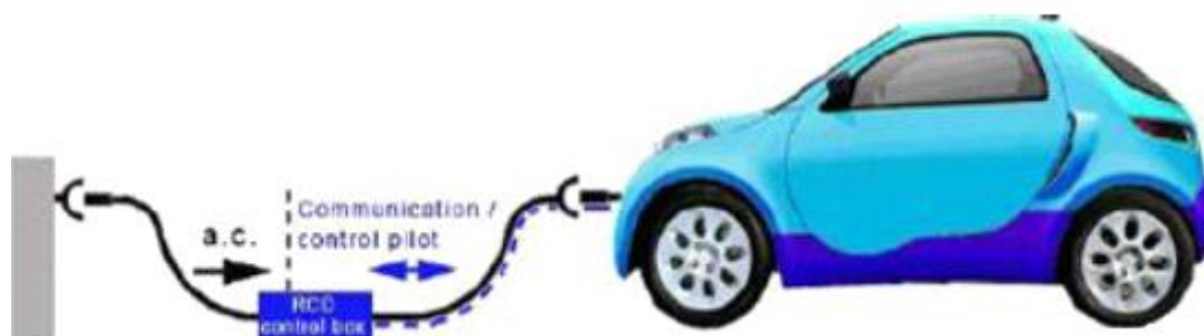
Figura 2.9 - Carregamento em modo 2
