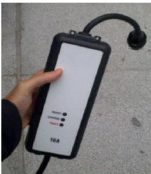
Figura 2.8 - ICCB - caixa de comando
