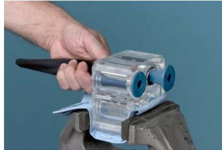
Enquanto mantém a flange da extremidade superior completamente apertada, puxe pela ferramenta de inserção.
