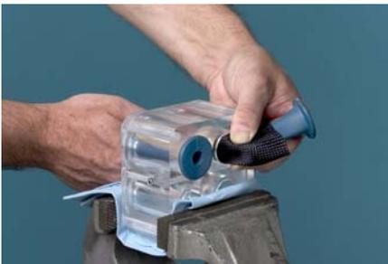
Introduza a extremidade superior da válvula de manga flexível na ferramenta de inserção de válvulas de manga flexível. Aperte completamente a flange da extremidade superior da válvula e introduza a extremidade pequena da flange completamente apertada no corpo de válvulas de manga flexível.
