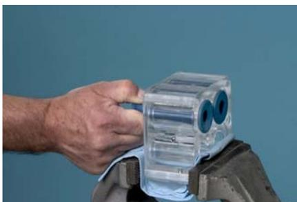
Coloque o corpo de válvulas de manga flexível, num torno de bancada com mordentes de protecção, com a extremidade inferior voltada para si. Segure e puxe a extremidade inferior da válvula de manga flexível com uma mão.
