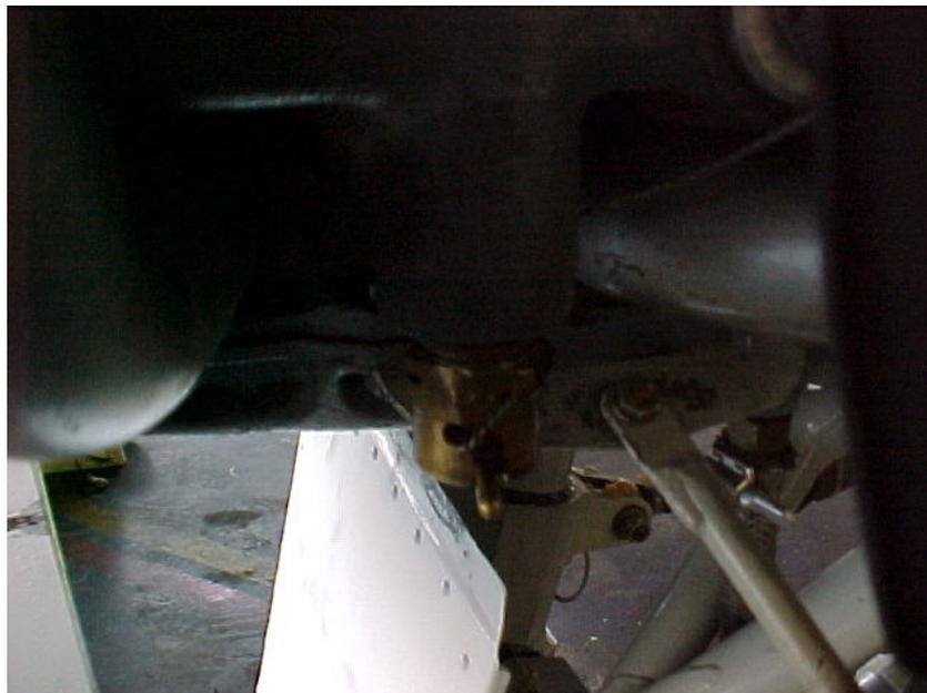
Figura 4 – Ponto inferior de coleta de amostra de óleo lubrificante.
