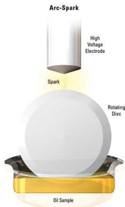
Figura 9 – Eletrodo de barra e disco criando e sustentando a descarga do arco, que resulta na criação do plasma (fonte: Practicing Oil Analysis Magazine).
