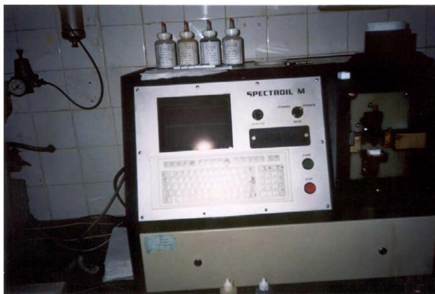
Figura 8 – Espectrômetro “Spectroil M” com seus padrões de calibração.
