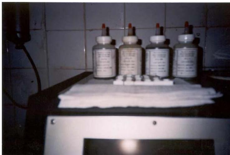
Figura 11 – Padrões de calibração do espectrômetro.
