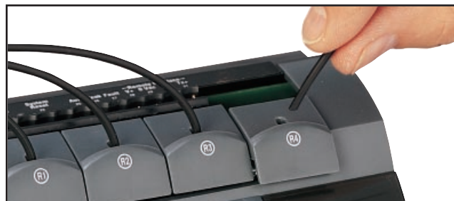
Figura 3-7. Instalação das extremidades preparadas no controle.
