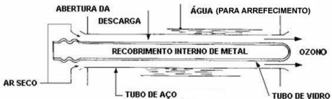
**Figura 3.4:** Esquema da célula geradora de ozono (Adaptado de Di Bernardo, 1993).
