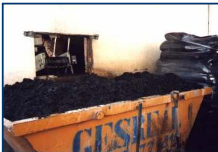
**Figura 3.15:** Lamas depois de saírem do filtro prensa (ETA de Monte Novo).
